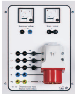
ST 13 Öffentliches Netz Dreiphasiger Wechselstromanschluss zum Anschluss des öffentlichen Netzes über eine 5-polige CEE Kupplung 16 A an das Schulungssystem. Adapter einphasig lieferbar.
