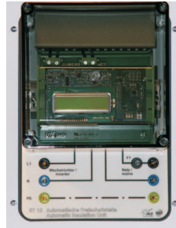
ST 12 Automatische Freischaltschleife
